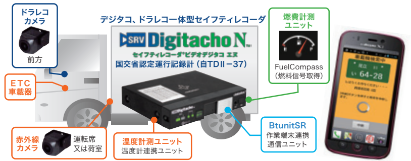
▲ SRV Digitacho Nには、前方用車載カメラ、運転席(または荷室)用赤外線カメラ、温度計測連携ユニットのほか、燃費計測ユニット「FuelCompass」と作業端末連携通信ユニット「BtunitSR」を搭載(図左)。端末は耐衝撃・防水・防塵に優れたMILスペック対応のスマートフォンを採用(SR連動アプリ「SRMessenger」や作業登録アプリをインストール、図右)
